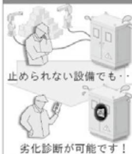
従来の劣化診断では設備の停電が必須であり、止められない重要設備ほど測定できないという問題点がありました。センサによる診断では運転中の設備でも測定が可能であるため、生産を止めることなく劣化診断を行えます。
