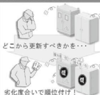
センサによる診断は、手軽に劣化度合いの比較が可能です。比較対象も配列ごとや電気室ごとなど、ご要望に合わせて選択が可能です。例) 複数設備にセンサを設置し、それぞれの劣化進展度合いを診断。使用限界までの期間が短い設備を優先的に更新することで、不具合発生リスクを最小限に抑えた更新計画の立案が可能。
