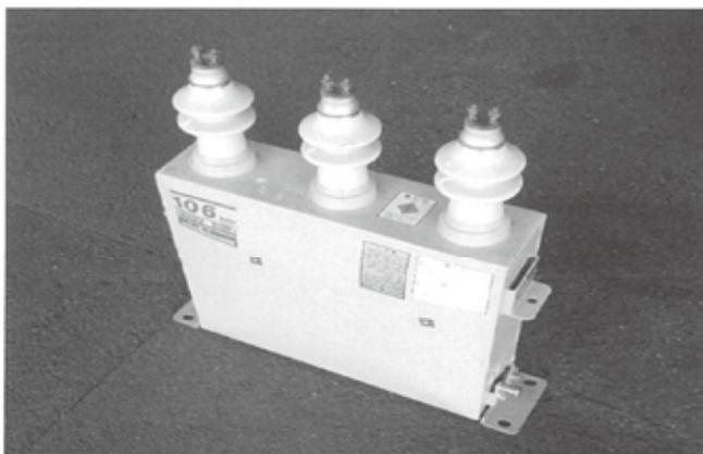
過電流により膨らんだ高圧コンデンサの一例
