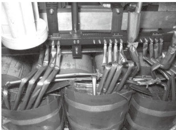
劣化事例：コイル過熱絶縁破壊(油入変圧器)
