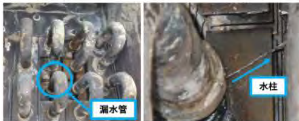
通水試験：水漏れ状況
