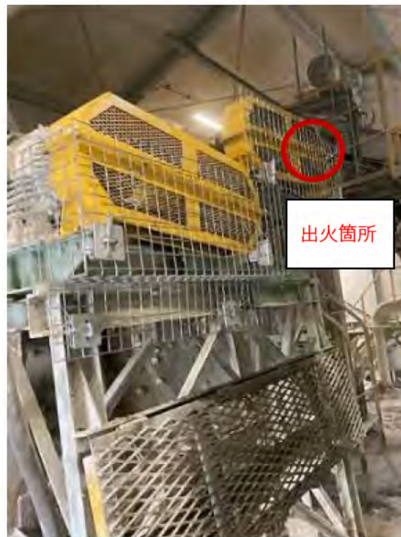
写真2 出火箇所（Vベルトカバー改造後）
