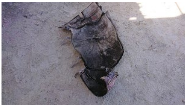
写真２ 出火したラギングカバー
