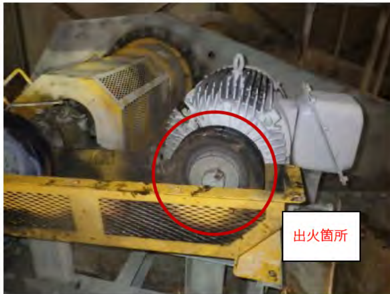
写真1 出火箇所（Vベルトカバーの上部を取り外した様子）
