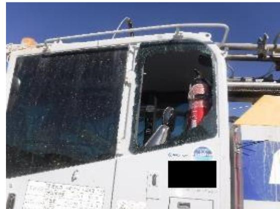
写真 6 穿孔機のガラス破損
