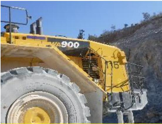
写真 3 ホイールローダの階段手摺破損
