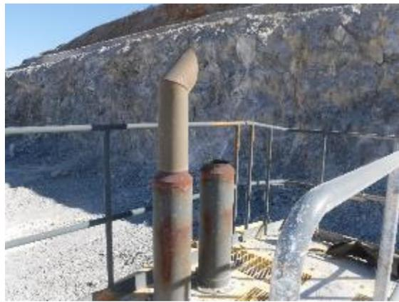
写真 4 ホイールローダのマフラー破損
