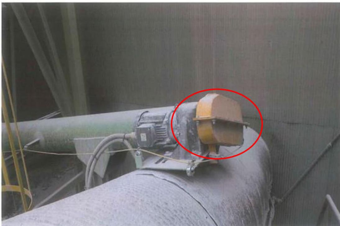
写真4 スクリューコンベア原動機チェーン駆動部カバー（対策実施後）
