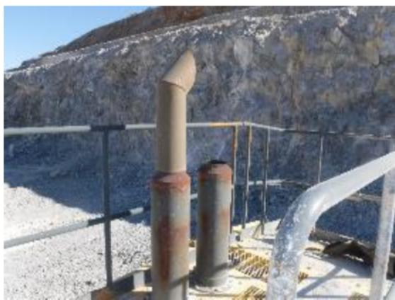
写真4 ホイールローダのマフラー破損
