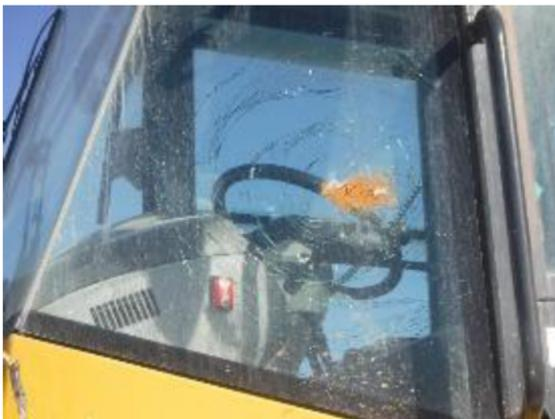
写真5 ホイールローダのガラス破損
